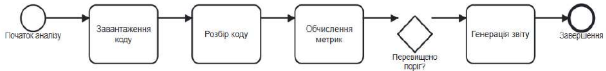
Рисунок 2 – Деталізована схема процесів у нотації BPMN
