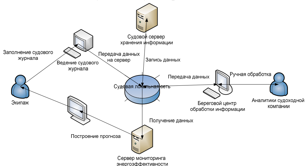
Рис. 2 – Схема мониторинга энергоэффективности судна
