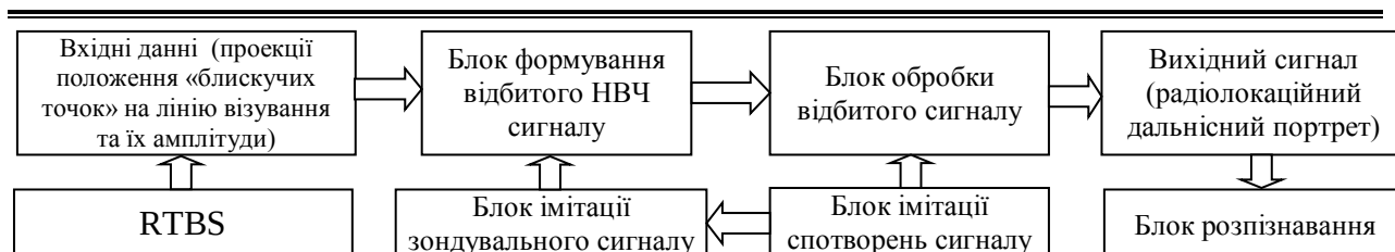
Рис. 1 – Блок-схема моделювання процесу розпізнавання об'єктів з урахуванням спотворень сигналу
